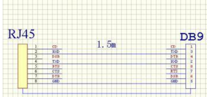
Figure3- 5 Konsol bağlantı noktasındaki kablo bağlantısı
