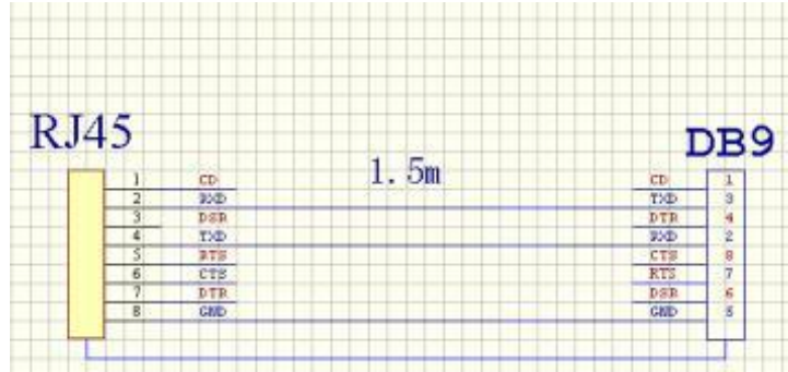
Figure3- 5 Konsol bağlantı noktasındaki kablo bağlantısı
